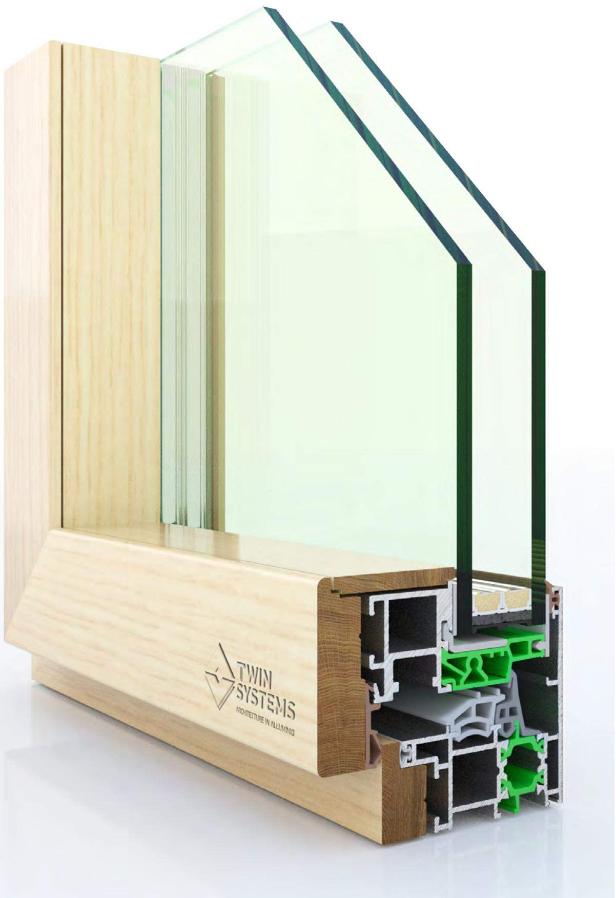
La particolare combinazione di legno e alluminio, unite in un unico elemento, garantisce una struttura solida, resistente e durevole nel tempo, che protegge l'ambiente interno dalle intemperie e dai rumori esterni. la vera particolarità di questo infisso è l'anta a scomparsa, che scompare completamente all'interno del telaio.
