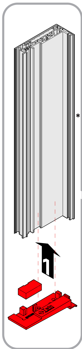
Montaggio Tappo di Tenuta Inferiore Bottom Sealing Cap Assembling
